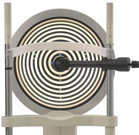
Fig. 15-4: Alineación en altura de la esfera de referencia
