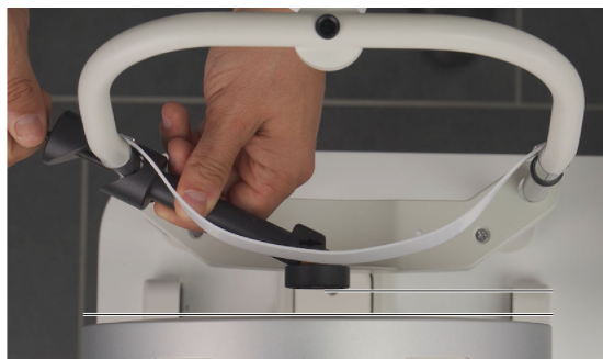
Fig. 15-3: Alineación de la esfera de referencia en paralelo (vista desde arriba del aparato)
