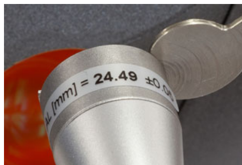
Fig. 9-4: Longitud del eje del ojo de prueba
