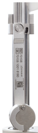
Fig. 9-2: Ojo de prueba en posición de estacionamiento
