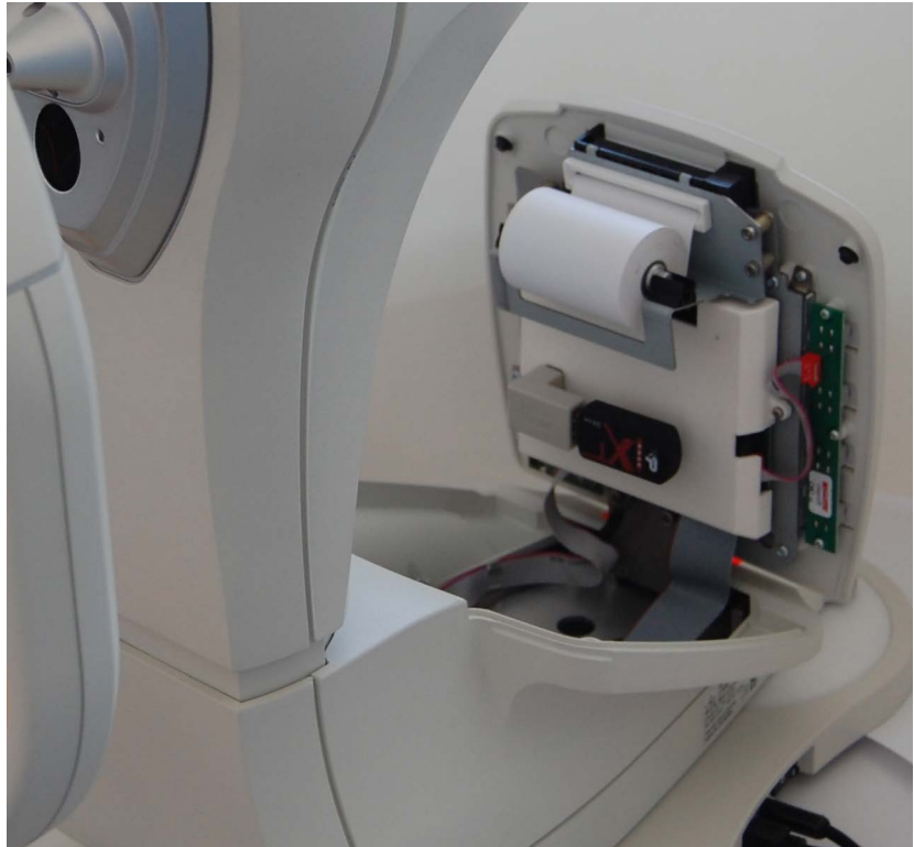
Fig. 13-4: Abrir a cobertura com o visor
