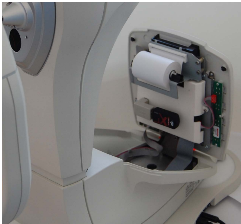
Fig. 8-1: Abrir a cobertura com o visor
