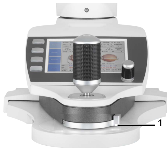
Fig. 14-4: Bloqueio do joystick
