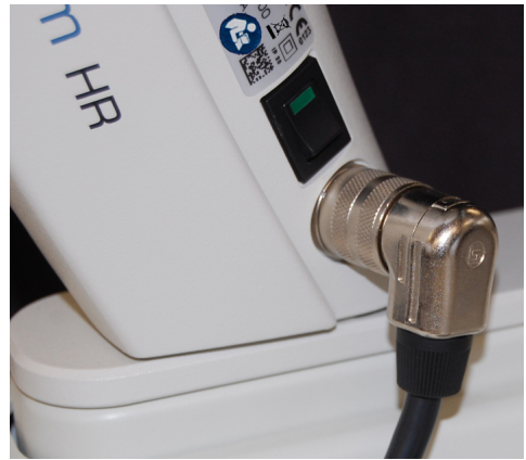
Fig. 10-1: retrait du câble en Y
