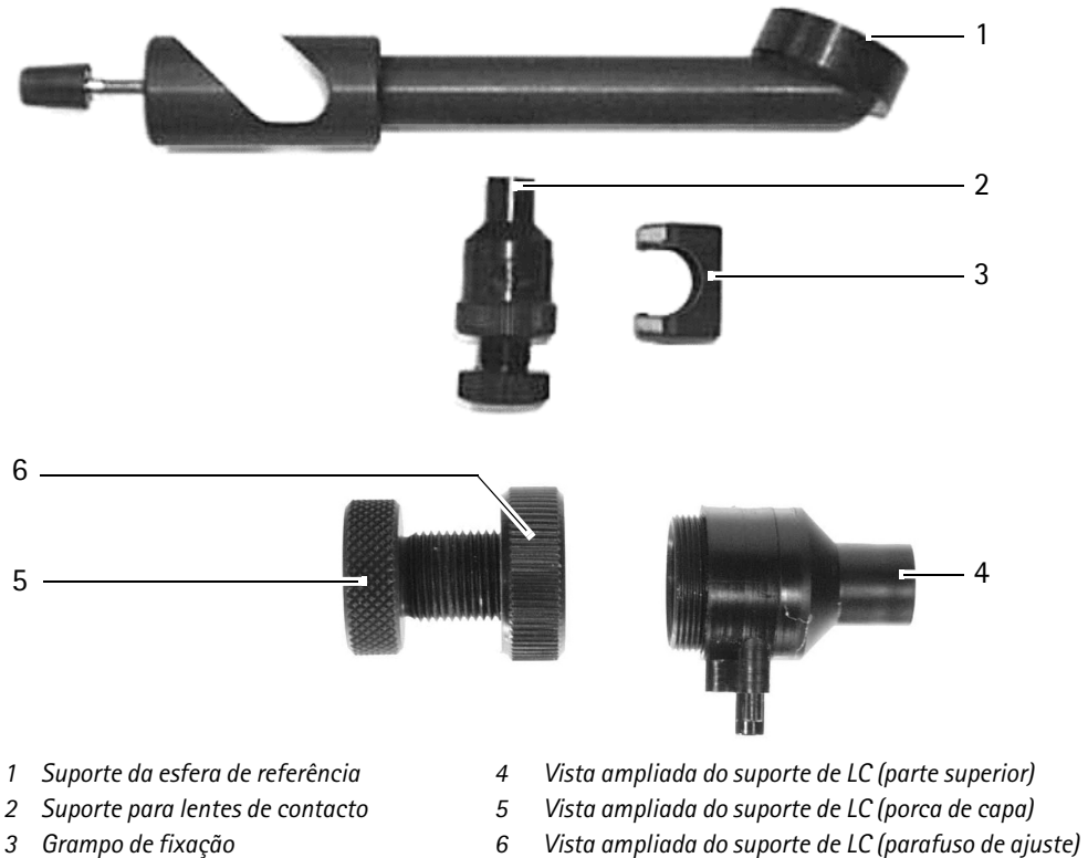
Fig. 10-10: Peças de montagem para medição das superfícies posteriores das lentes de contacto
