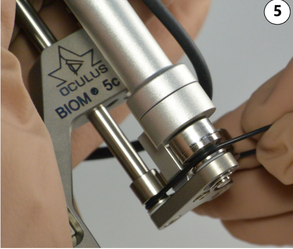
Şekil 9-3: Tahrik kayışının ve kablo kanalının monte edilmesi
