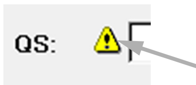
Fig. 14-5: Indication de maintenance à effectuer
