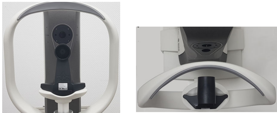
Fig. 14-1: Olho de teste instalado
