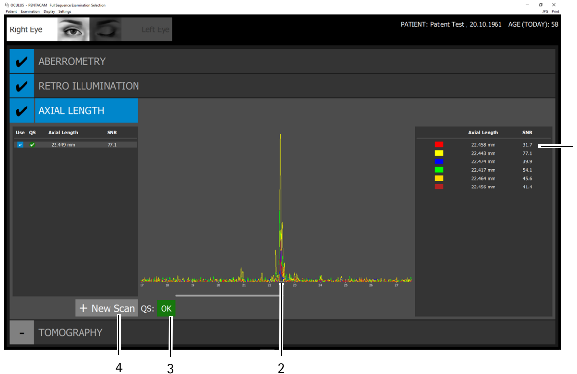
1 Scansione singola con valori SNR 2 Rapporto segnale/rumore della misurazione della lunghezza assiale 3 Valore "QS" 4 Pulsante [+New Scan] (+Nuova scansione) Fig. 11-14: Programma Pentacam® AXL Wave con indicazione "QS"
