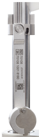
Fig. 13-2: Occhio di prova in posizione di parcheggio/home
