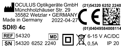
Abb. 2-1: Typenschild SDI® 4c
