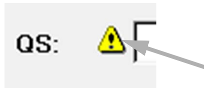
Fig. 10-5: Hinweiszeichen, dass eine Wartung erforderlich ist
