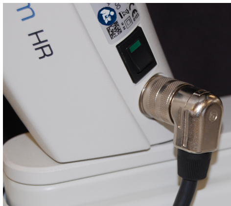
Fig. 10-1: Deconectați cablul Y
