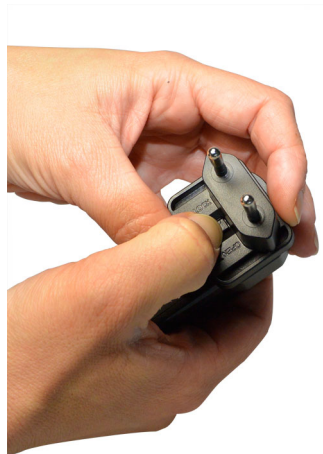
Fig. 7-4: Inserire l'adattatore per l'alimentatore (esempio) specifico per il rispettivo Paese
