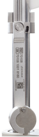
Εικ. 13-2: Οφθαλμός δοκιμής στη θέση στάθμευσης
