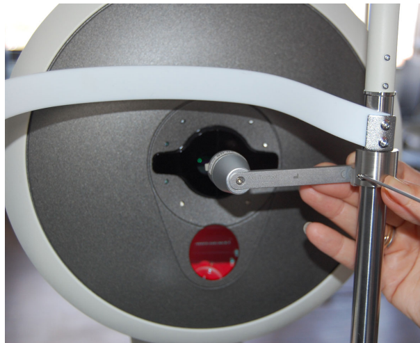
Εικ. 13-1: Τοποθέτηση οφθαλμού δοκιμής
