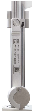
Fig. 13-2: Occhio di prova in posizione di parcheggio
