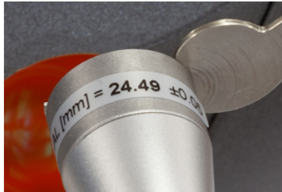
Fig. 13-4: Lunghezza dell'asse dell'occhio di prova
