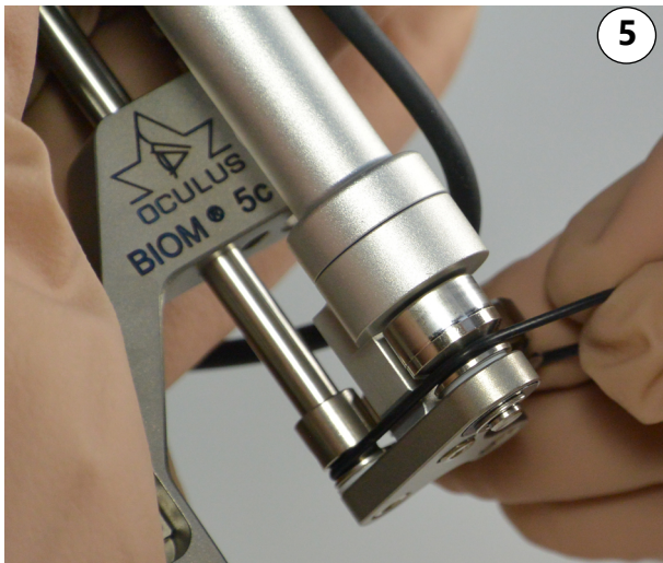
Fig. 9-3: Montaggio della cinghia di trasmissione e della guida del cavo
