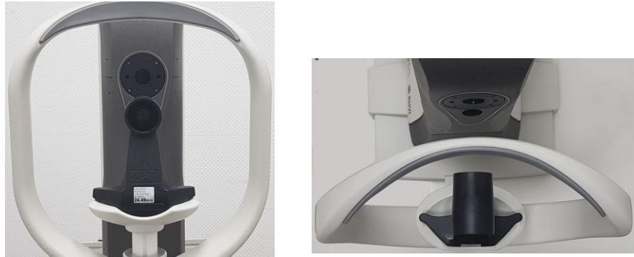
Fig. 14-1: Occhio di prova installato
