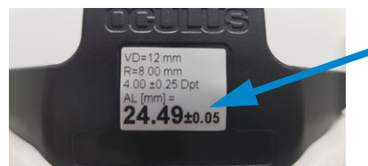
Fig. 14-2: Esempio: Misurazioni con l'occhio di prova
