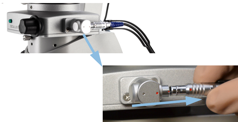
Fig. 9-12: BIOM® 5c/cl: Afloje las conexiones de enchufe
