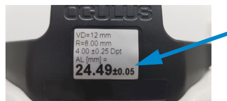
Fig. 10-2: Exemple : résultats sur l'œil de test
