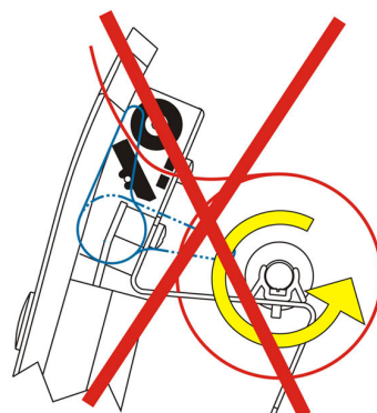
Fig. 11-5: Guidage incorrect du papier
