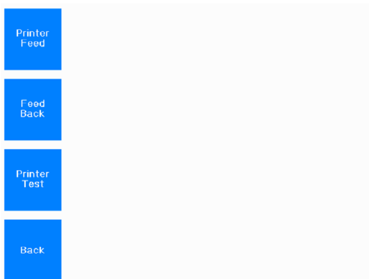
Фиг. 16-3: Дисплей за преместване на ролката принтерна хартия напред и назад
