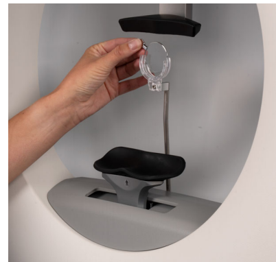
Fig. 18: Mise en place d'un verre correcteur
