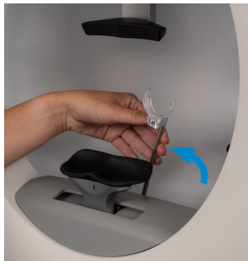
Fig. 17: Mettre en place le support pour verre
