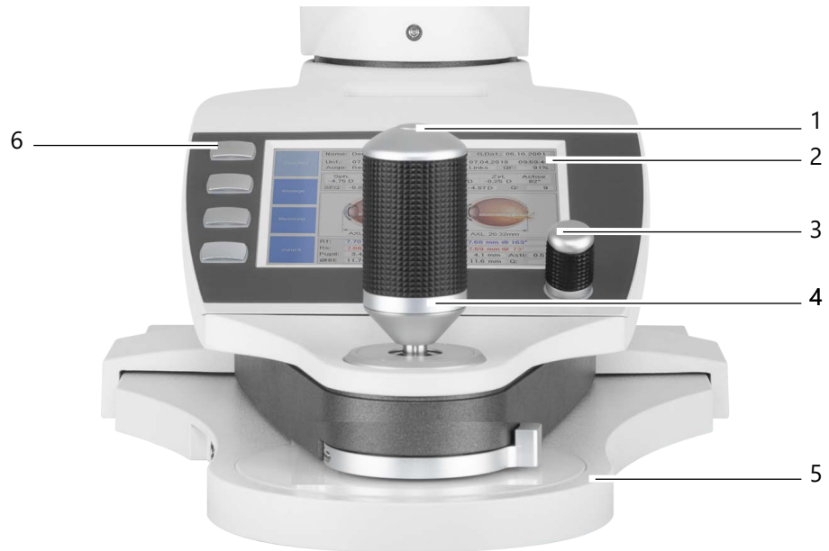
Abb. 6-1: Funktionen der Bedieneinheit
