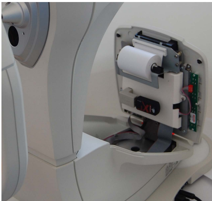
Obr. 18-2: Otevření krytu s displejem
