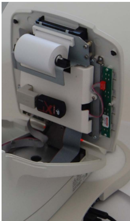
Obr. 8-1: Otevření krytu s displejem
