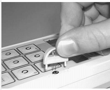
Fig. 13-6: Remplacement de la lampe
