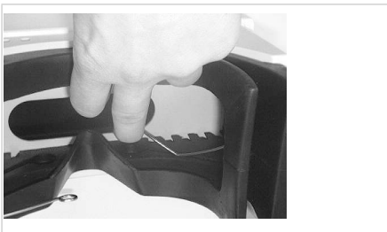
Fig. 13-2: Retrait d'un ressort à étrier
