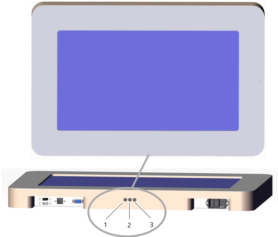
Abb. 11-5: Service-Knöpfe an der Unterseite des Vissard 3D/Vissard RG
