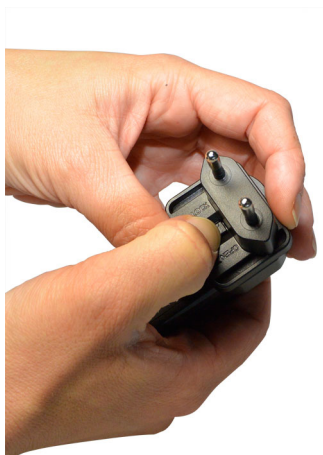
Fig. 7-4: Inserte el adaptador específico del país para la fuente de alimentación (ejemplo)
