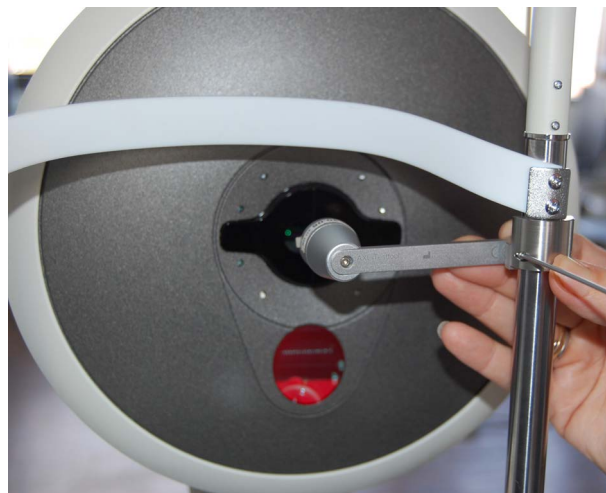
Rys. 13-1: Montaż oka testowego
