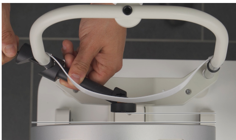
Fig. 21-4: Orienter les billes de référence en parallèle (vue depuis le dessus de l'appareil)
