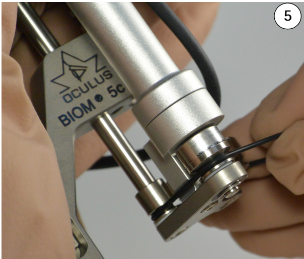
9-3. ábra: Hajtósíj és a kábelvezető felszerelése
