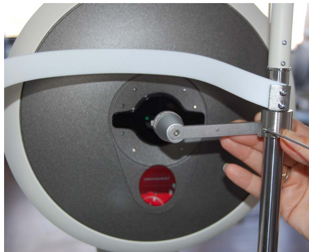
Fig. 13-1: Montage de l'œil de test
