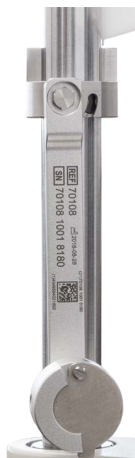
Fig. 13-2: Œil de test en position de rangement
