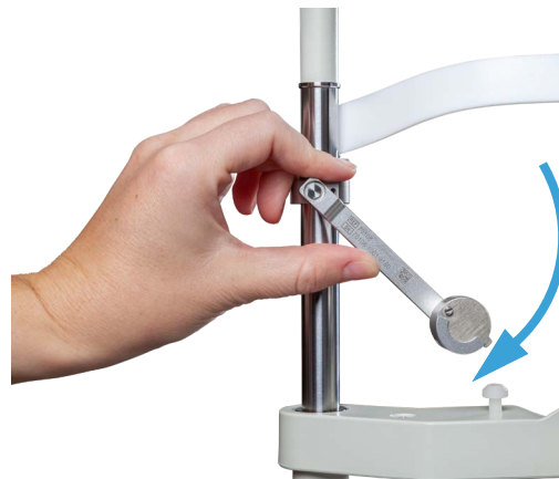
Fig. 13-3: Basculement de l'œil de test vers le bas
