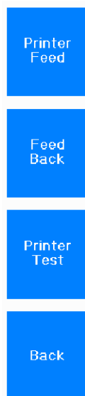
Fig. 16-3: Display per l'avanzamento e la ritrazione del rotolo di carta da stampa
