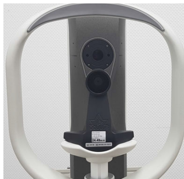
Fig. 14-1: Occhio di prova installato
