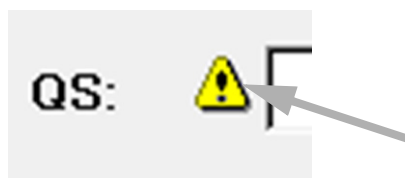
Fig. 15-5: Hinweiszeichen, dass eine Wartung erforderlich ist
