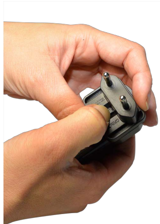
Fig. 7-4: Länderspezifischen Adapter für das Netzteil (Beispiel) einsetzen
