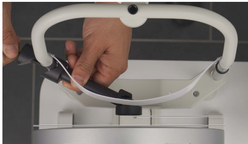
Fig. 21-4: Alinear la bola de referencia en paralelo (vista desde arriba hacia el aparato)
