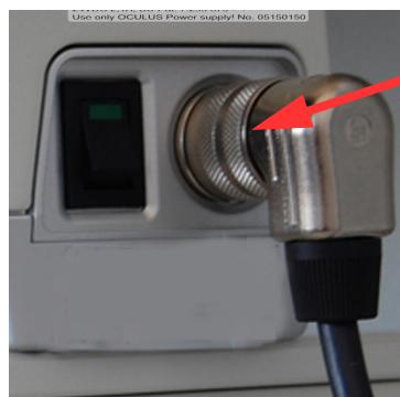
Fig. 23-1: Aflojar la conexión atornillada del cable de aislamiento seguro méd.
