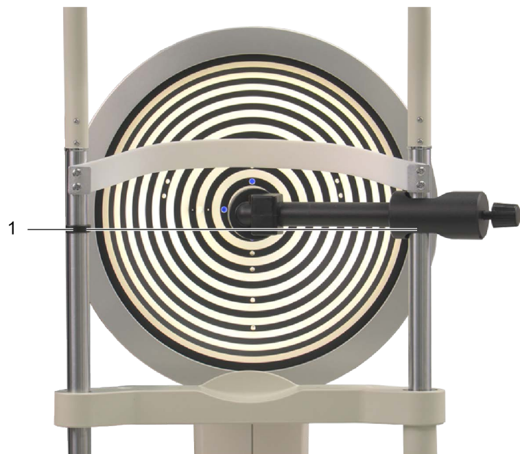
Fig. 21-5: Alinear en altura la bola de referencia
