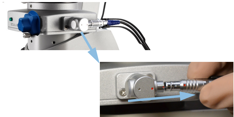
图 9-12: BIOM® 5c/c1: 松开插拔连接
