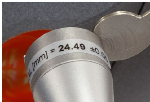
Slika 9-4: Aksijalna duljina testnog oka
