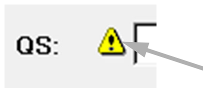
Afb. 14-5: Aanwijzingsindicatie dat onderhoud nodig is
