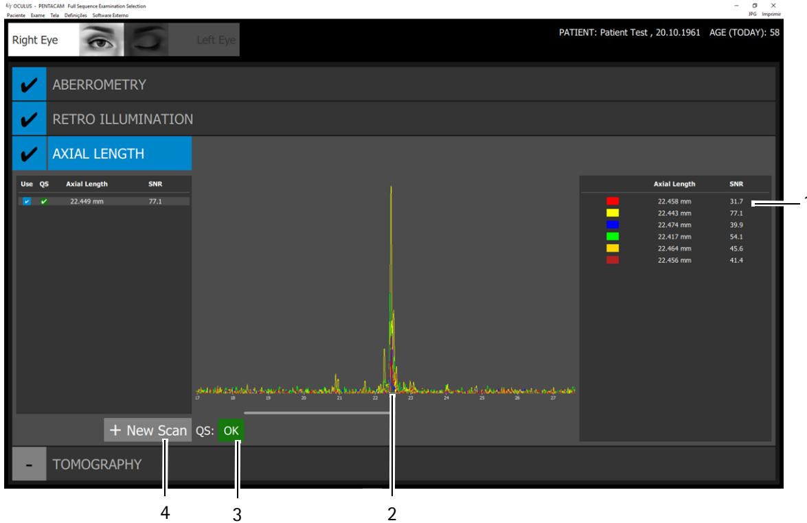
1 Análises únicas com valores SNR 2 Relação sinal-ruído da medição do comprimento axial 3 Valor "QS" 4 Botão [+New Scan] (+Nova análise) Fig. 11-14: Programa Pentacam® AXL Wave com ecrã "QS"
