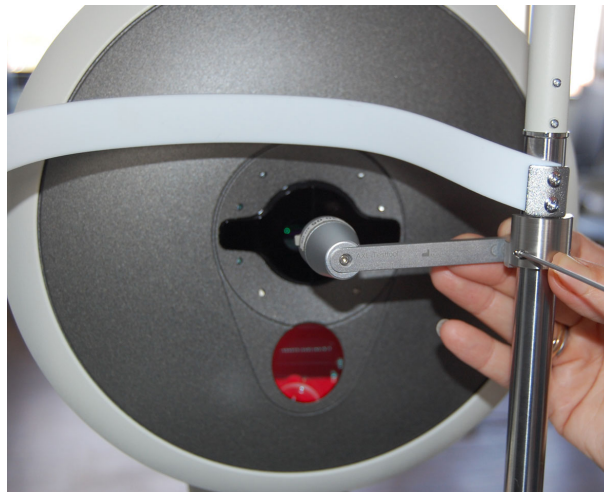
Fig. 10-1: Instalar o olho de teste
