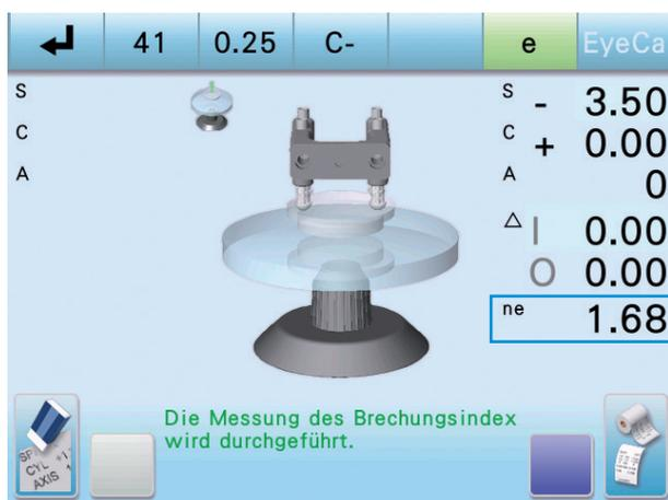
Kunden wünschen vom Augenoptiker oft den Ersatz eines Glases in einer Brille, die er nicht angefertigt hat. Mit dem optional erhältlichen Gel Pads Set (Go-Meisan) wird die Brechzahl eines Glases gemessen. So ist es einfach, das verlorene Glas mit der korrekten Brechzahl einer Fremdbrille zu ersetzen.
