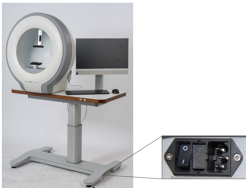
Fig. 7: Interruttore generale alla base del tavolo (in caso di utilizzo con tavolo elevatore OCULUS)
