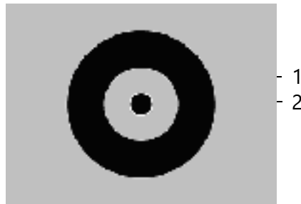
1 Streulichtquelle (äußerer Ring) 2 Zentrales Testfeld Abb. 11-2: Kompensationsvergleich
