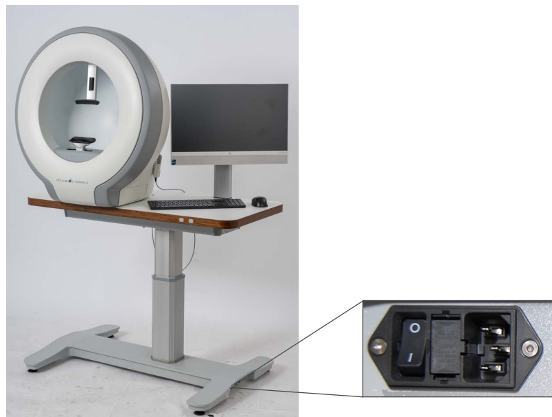
Abb. 5-1: Hauptschalter am Tischfuß (bei Verwendung mit OCULUS Hubtisch)
