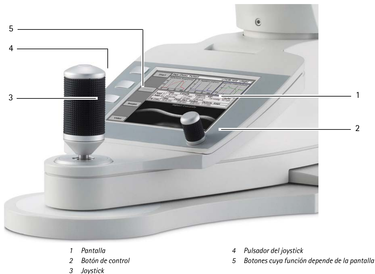
Fig. 11-1: Funciones de la unidad de control
