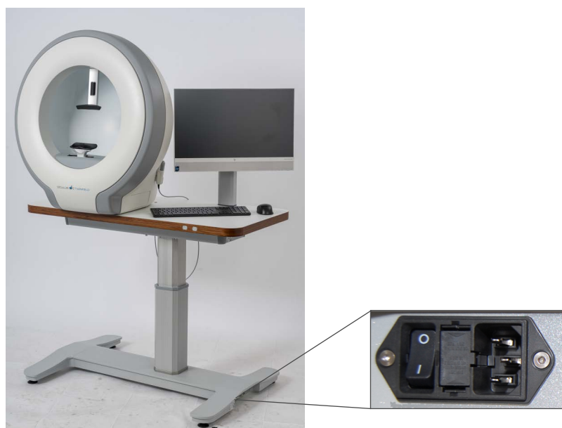
Obr. 7: Hlavní spínač na patě stolku (při použití se zvedacím stolem OCULUS)
