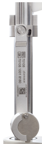
Fig. 13-2: Occhio di prova in posizione di parcheggio/home
