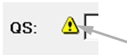
Fig. 14-5: Segnale che indica la necessità di una manutenzione
