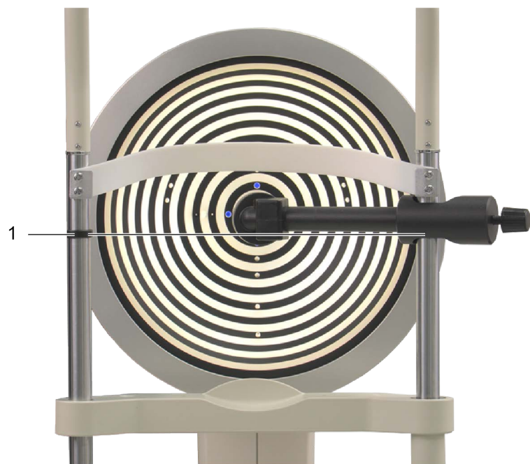
Fig. 21-5: Allineamento dell'altezza della sfera di riferimento
