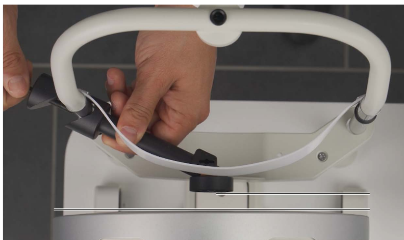
Fig. 21-4: Allineare parallelamente la sfera di riferimento (vista dall'alto sul dispositivo)
