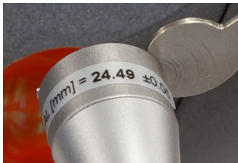
Fig. 9-4: Mesure de la longueur d'axe sur l'œil de test
