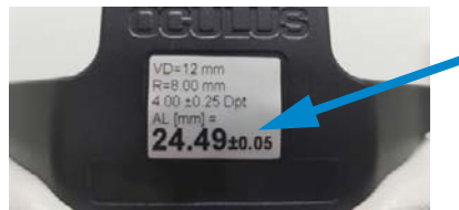
Sl. 14-2: Primer: Rezultati s preskusnim očesom Sistem je zdaj pripravljen na uporabo.
