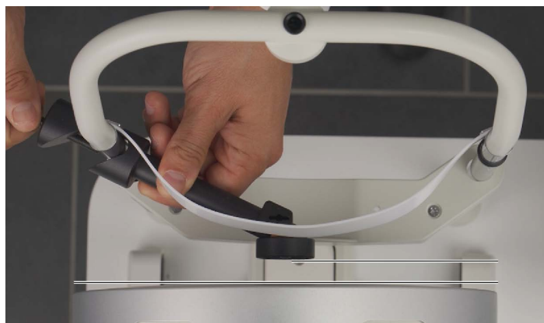
Fig. 21-4: Alinhe a esfera de referência paralelamente (vista de cima no dispositivo)
