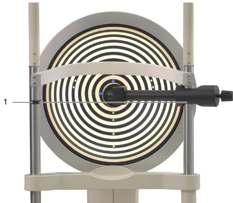
Fig. 21-5: Alinhe a esfera de referência em altura
